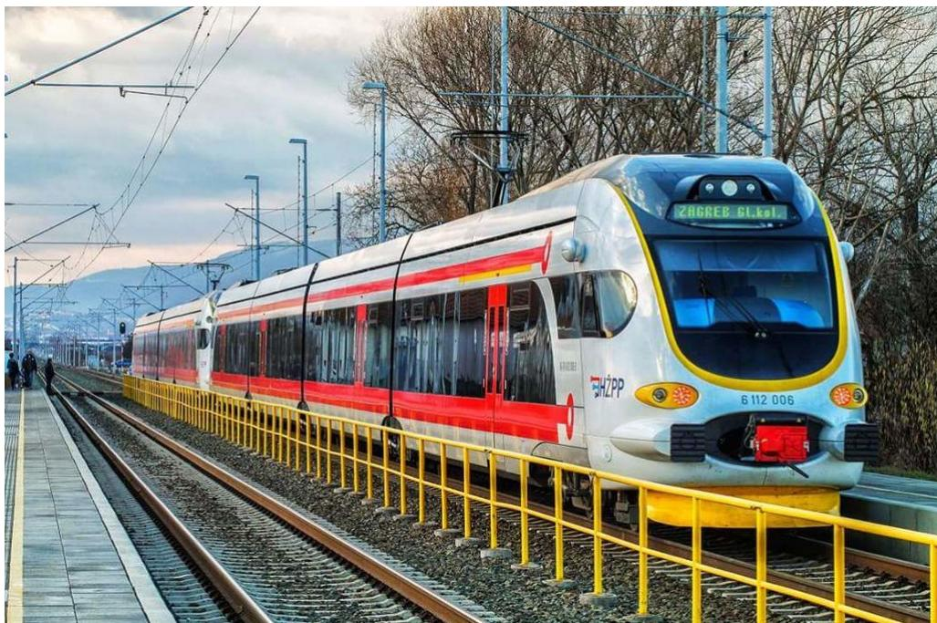
**Slika 2.5.** Niskopodni elektromotorni vlak serija 6112
