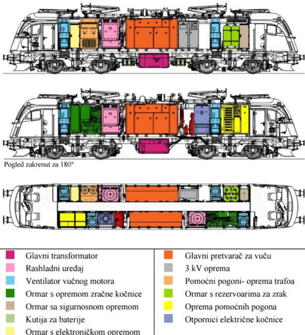
**Slika 5.2.** Raspored glavnih komponenata (masa) unutar lokomotive Siemens ES64U4
