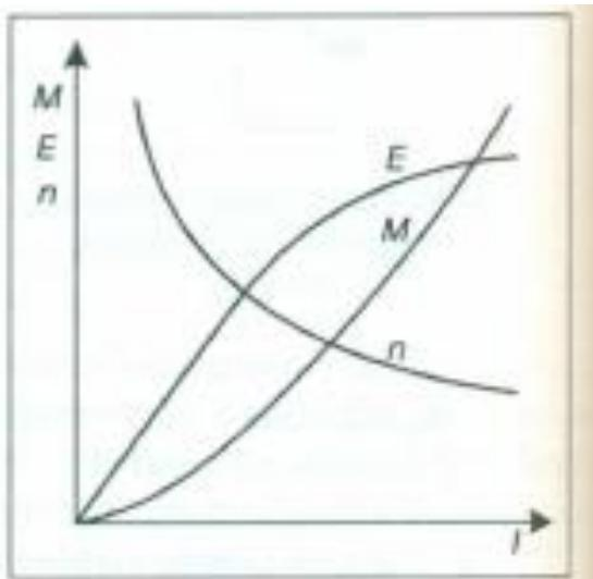
**Slika 3.3.** Veličine istosmjernog serijskog elektromotora
