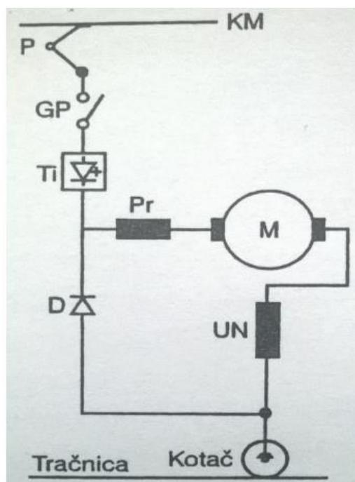
**Slika 3.4.** Tiristorska regulacija brzine u sustavu istosmjerne struje
