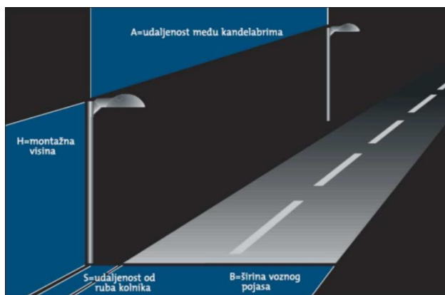
Slika 8. Geometrija postavljanja svjetiljki, [10]
