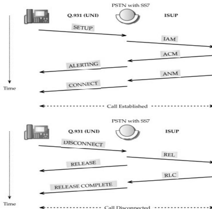
Slika 14. Tijek poziva: uspostava i završetak između Q.931 i SS7 ISUP
