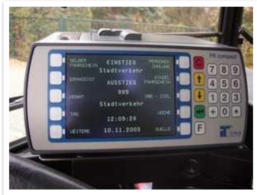
Slika 10. Računalo vozila (FRcity) [15]
