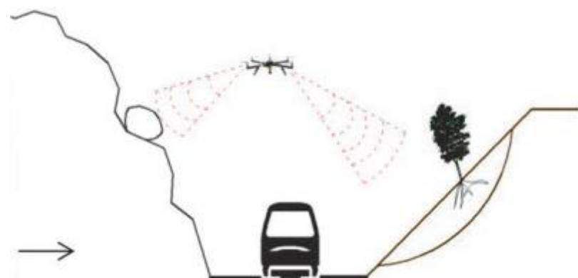
**Slika 8.** Određivanja volumena stijenskih blokova daljinskim mjerjenjem primjenom bespilotne letjelice, [7]
