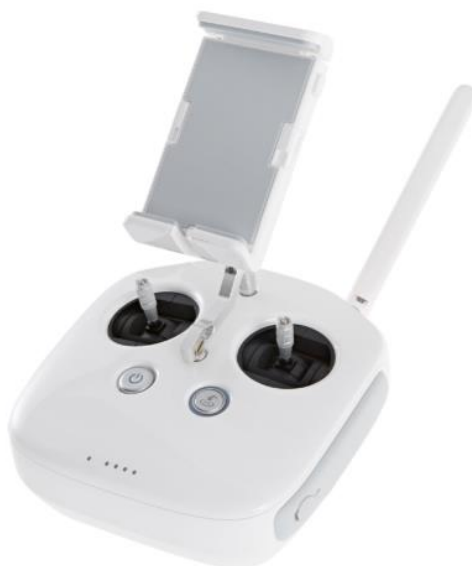
Slika 11. Daljinski upravljač letjelice Phantom 4, [9]
