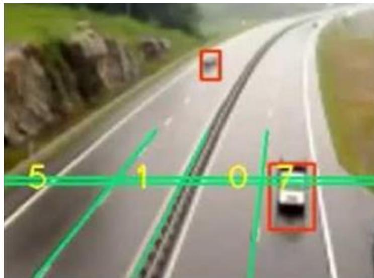
Slika 18. Ulazna virtualna vrata na autocesti, [13]
