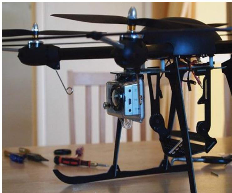
*Slika 5. Primjer integracije senzora, Quadcopter, [5]*
