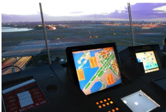
Slika 2 Zaslon *Surface Movement Radar-a*
