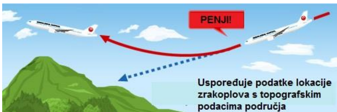
Slika 15. Načelo rada GPWS sustava [33]
