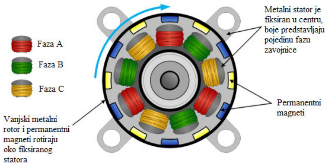
**Slika 18.** Motor bez četkica s vanjskim pokretnim dijelom [18]
