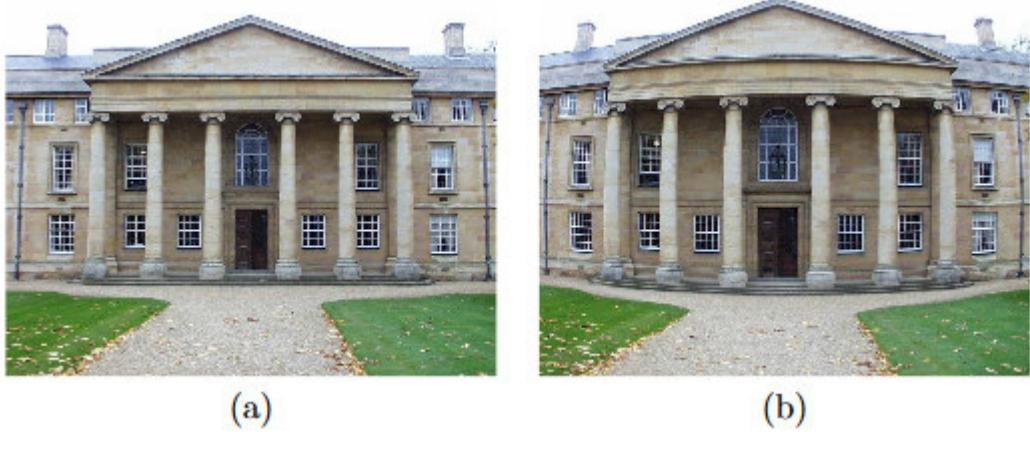
**Slika 25.** Radijalna distorzija. (a) Slika bez distorzije. (b) Slika s radijalnom distorzijom, točke su radijalno pomaknute od centra slike, [26]
