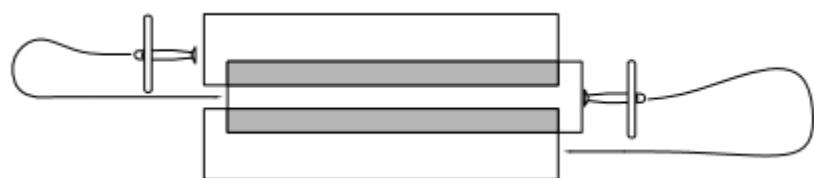
**Slika 15.** Poprečni preklop tri uzastopna niza, [14]
