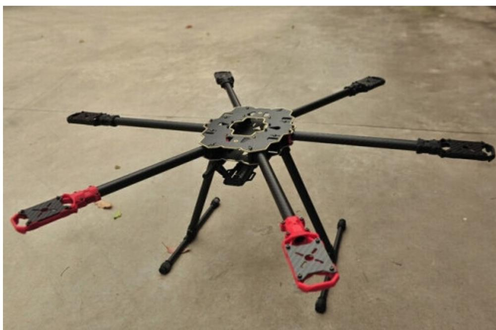
**Slika 17.** Okvir multirotora
