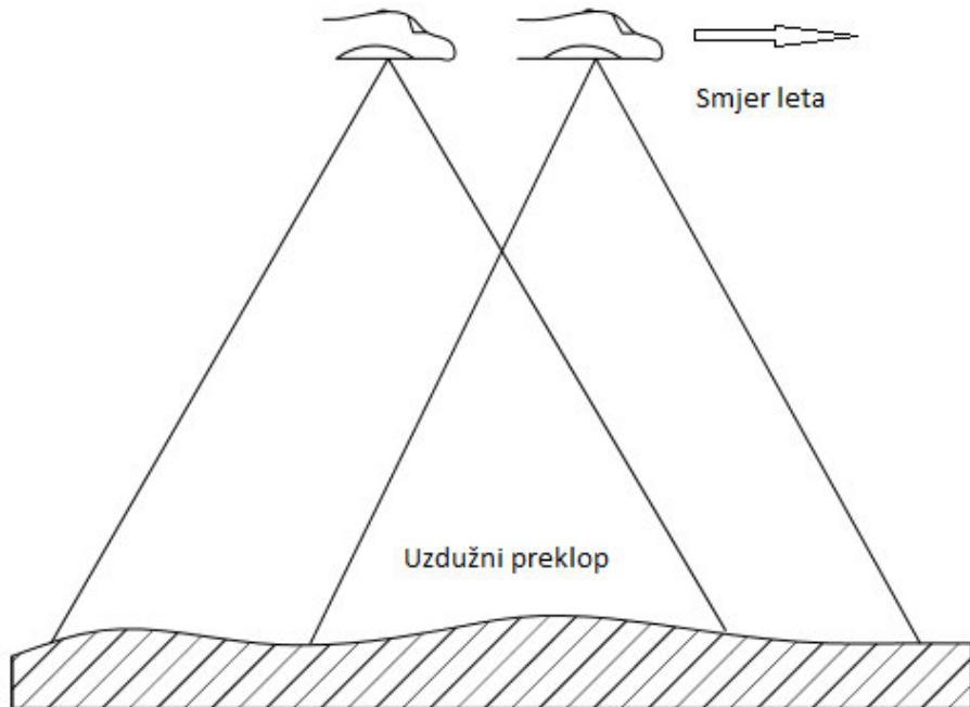
**Slika 13.** Uzdužni preklop, [14]
