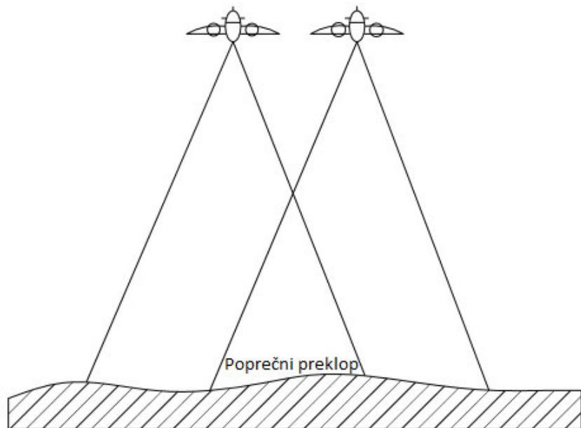
**Slika 14.** Poprečni preklop, [14]
