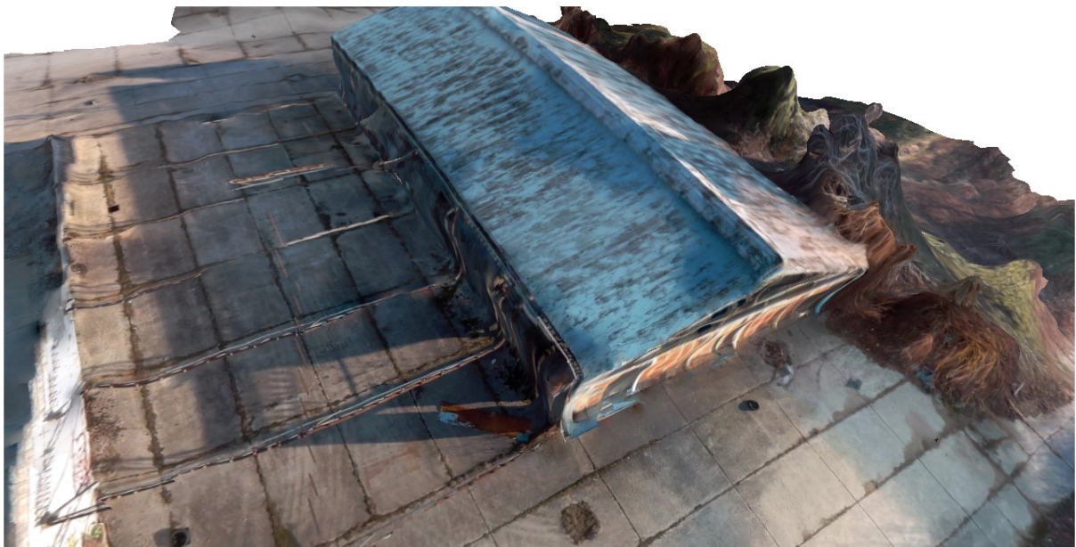
Slika 57. DEM trokutna mreža s dodanom teksturom, na osnovu snimka iz zraka
