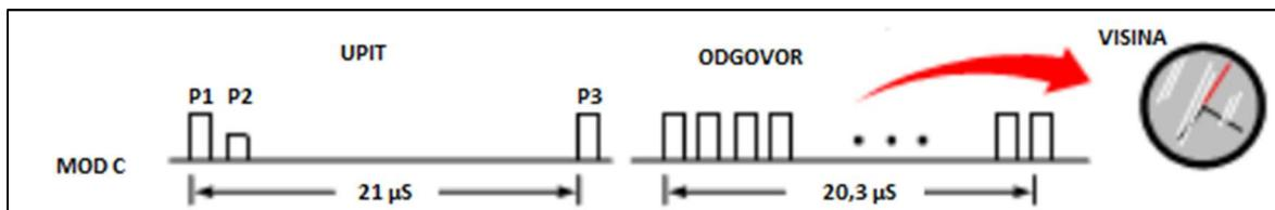
Slika 7. Princip rada moda C [8]
