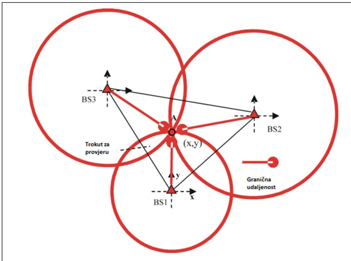
Slika 13: Princip određivanja pozicije za 3 poznate stanice [8]
