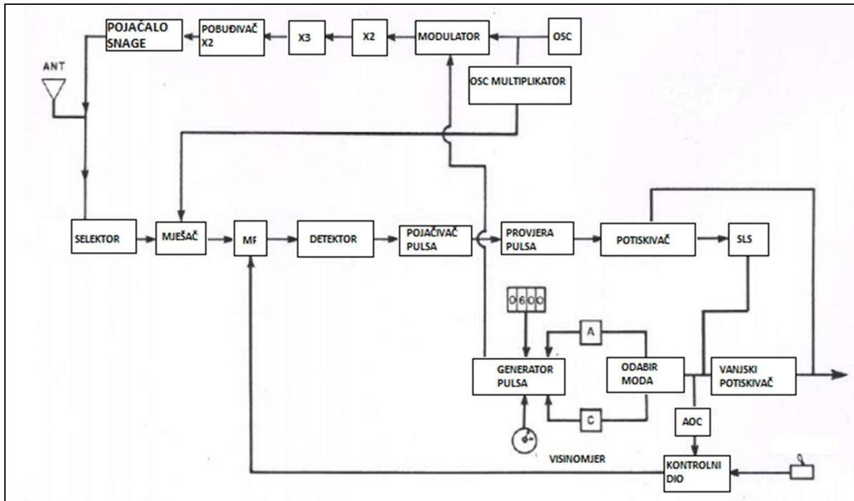
Slika 5. Blok shema avionskog transpondera [8]
