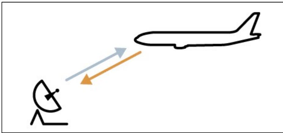
Slika 2. Princip rada sekundarnog nadzornog radara [5]
