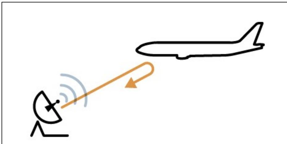
Slika 1. Princip rada primarnog nadzornog radara [4]
