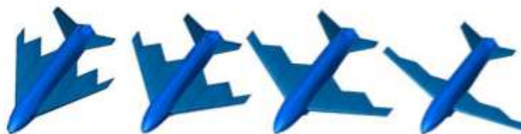
Slika 27. Hypercomp / NextGen tip morfirajućeg krila Izvor: [8]
