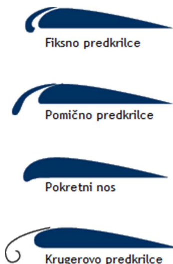
Slika 22. Razne vrste predkrilaca Izvor: http://slideplayer.com/slide/4207302/ , (pristupljeno: lipanj 2016.)
