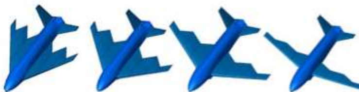
Slika 27. Hypercomp / NextGen tip morfirajućeg krila Izvor: [8]
