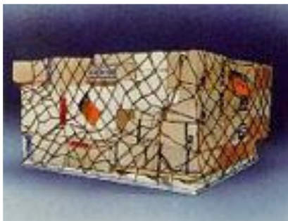
Slika 2. Paleta PAG (izmjere: 208 x 302 cm, volumen: 10,48 m 3 , max. neto težinski kapacitet: 10 626 kg) [21]
