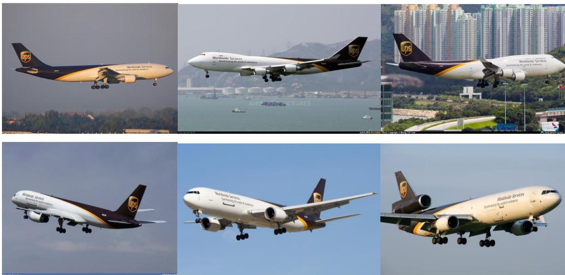
Slika 25. Flota UPS Airlines prijevoznika: Airbus A300-600RF (gore lijevo) [44] Boeing 747-400F (gore sredina) [45] Boeing 747-400BDSF (gore desno) [46] Boeing 757-200PF (dolje lijevo) [47] Boeing 767-300F (dolje sredina) [48] McDonnell Douglas MD-11F (dolje desno) [49]
