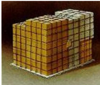
Slika 3. Paleta PMC (izmjere: 205 x 300 cm, volumen: 10,6 m<sup>3</sup>, max. neto težinski kapacitet: 11 835 kg) [21]
