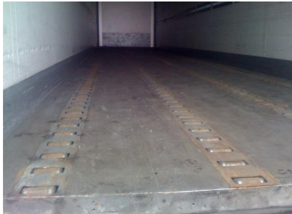
Slika 14. Unutrašnjost kamiona opremljenog valjcima za prihvat i otpremu zrakoplovnih paleta [21]
