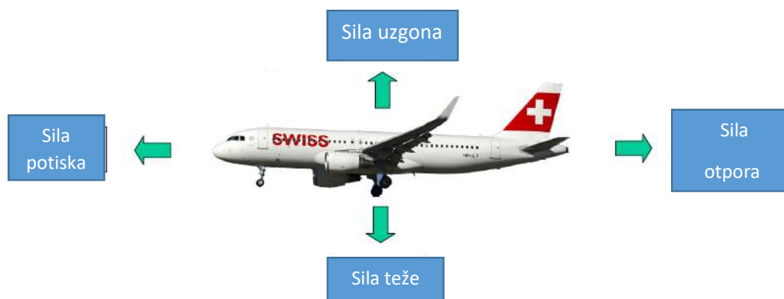
Slika 2.1. Sile koje djeluju na zrakoplov u letu
