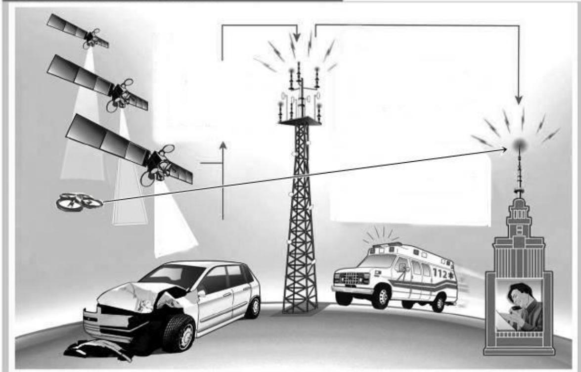
**Slika 22.** Način rada eCall sustava
