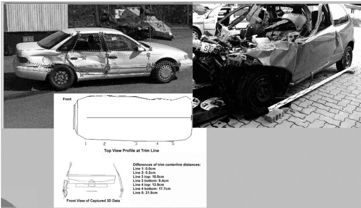
Slika 8. Označavanje, klasifikacija i osiguranje tragova na vozilu
