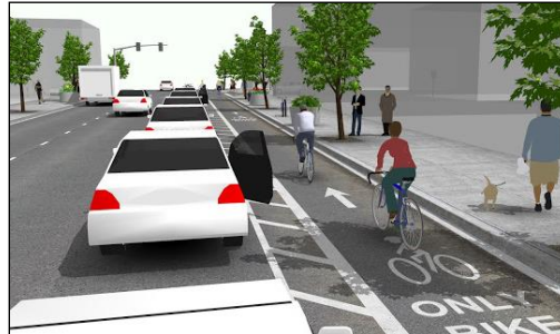
Slika 17. Biciklistička traka sa sigurnosnom zonom između
