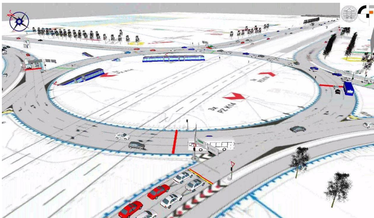
Slika 7: Prijedlog rješenja rekonstrukcije raskrižja Avenija Dubrovnik – Rotor
