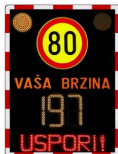
Slika 17. Radarski pokazivač brzine[17]
