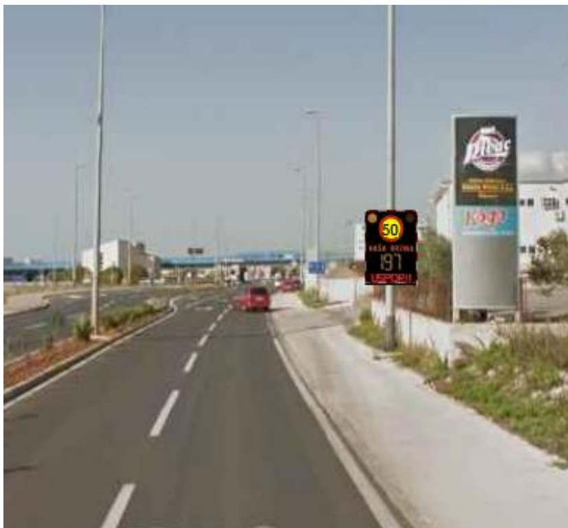
Slika 14. Prijedlog rješenja sa radarskim pokazivačem brzine
