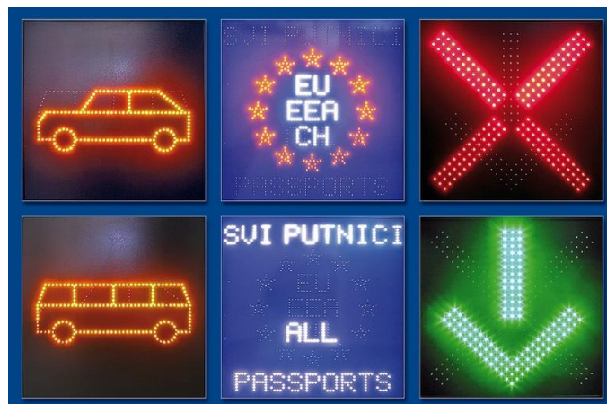
Slika 52. Promjenjivi prometni znak izrađen u LED tehnologiji [24]
