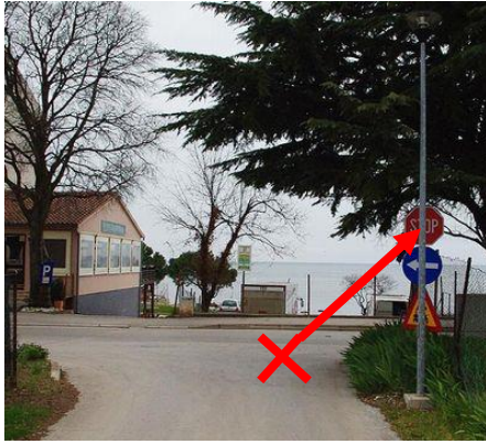
Slika 36. Loša vidljivost prometnih znakova [17] Slika 37. Prometni znak na nepropisnoj visini [18]
