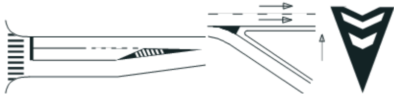
Slika 21. Primjeri polja za usmjeravanje prometa [15]
