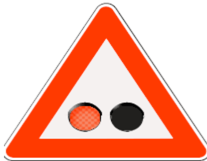
Slika 27. Ploča sa svjetlima koja označava prijelaz preko pruge u razini [15]
