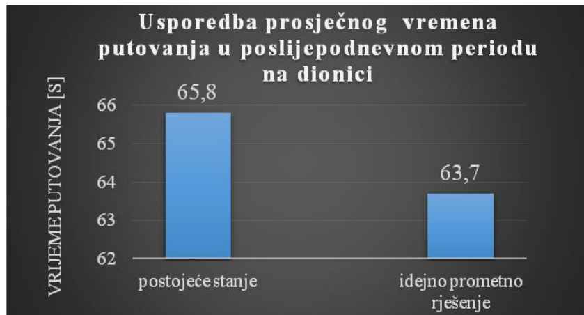
Grafikon 8. Usporedba prosječnog vremena putovanja postojećeg stanja i predloženog idejnog rješenja dionice u poslijepodnevnom periodu
