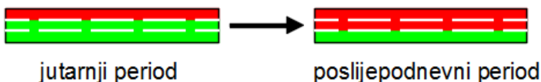
Slika 38. Shematski prikaz dinamičkih traka u smjeru prema centru grada
