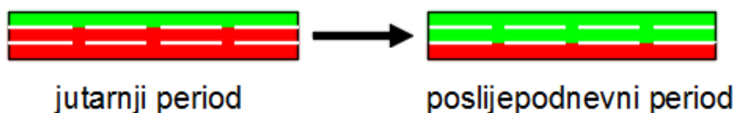
Slika 39. Shematski prikaz dinamičkih traka u smjeru iz centra grada
