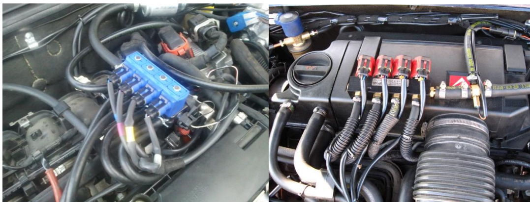
Slika 4. Različiti sustavi za ubrizgavanje autoplina na benzinskim motorima
