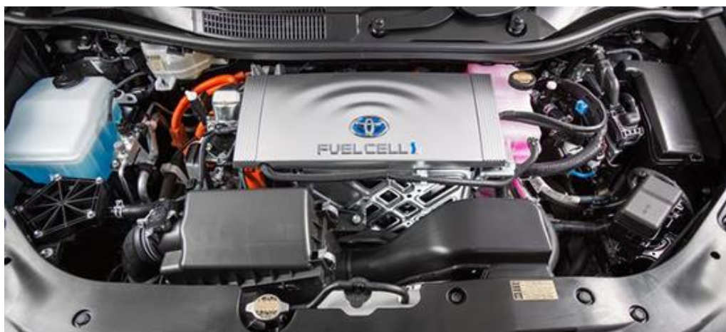
Slika 9. Spremnika gorivih ćelija na motoru Toyote Mirai
