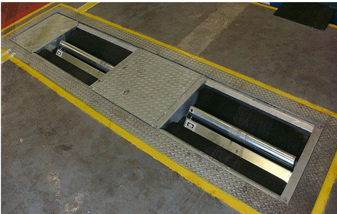
Slika 4. Valjci za testiranje kočionog sustava, [10].
