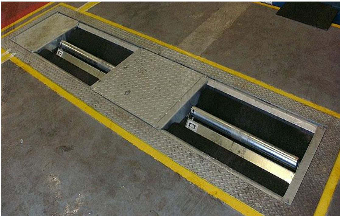
Slika 4. Valjci za testiranje kočionog sustava, [10].
