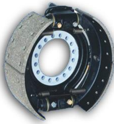
Slika 4. Duplex kočni sustav
