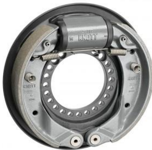
Slika 2. Simplex kočni sustav
