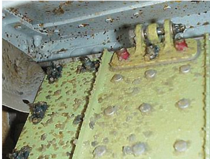
Slika 13. Zgusnuta nakupina tekućine za zaštitu zrakoplova od zaleđivanja
