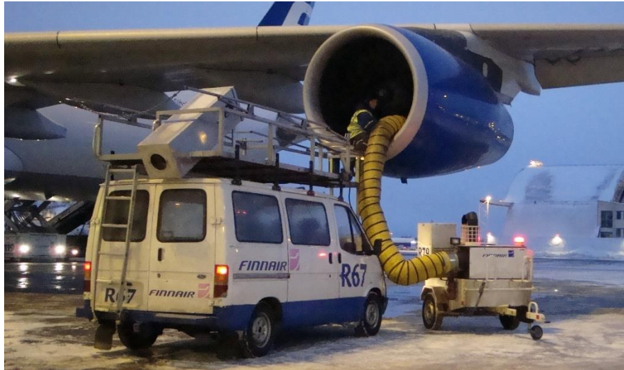
Slika 12. Odleđivanje lopatica kompresora motora vrućim zrakom
