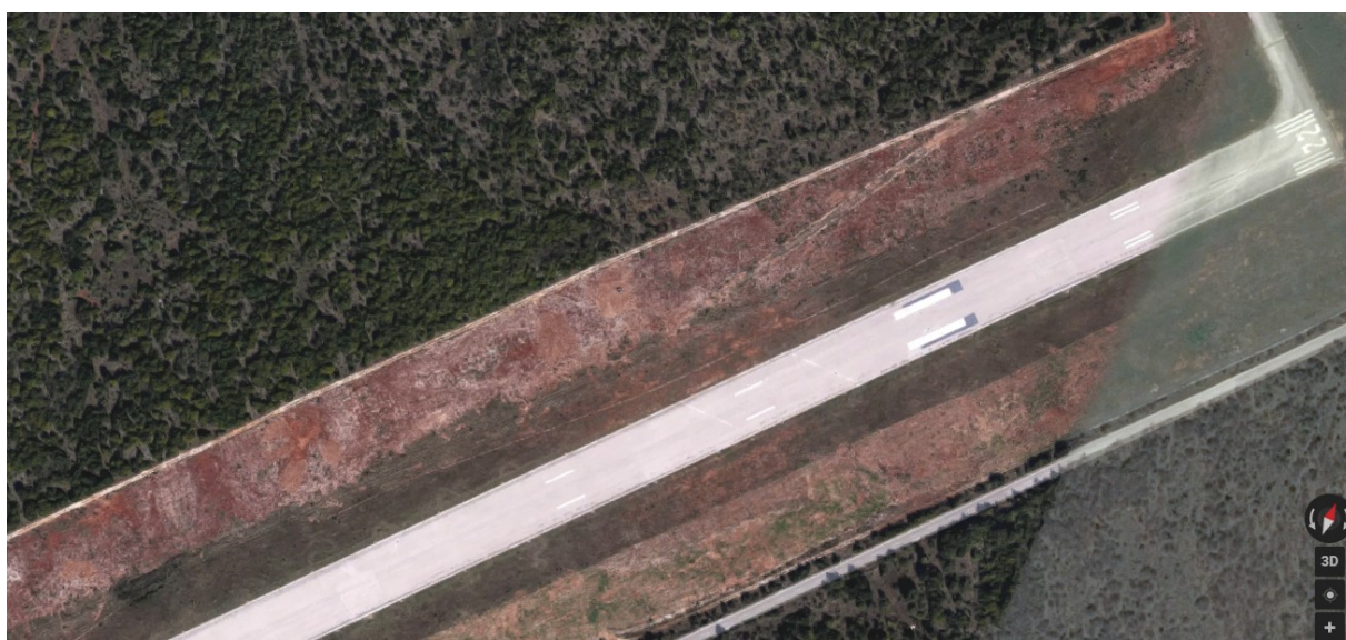
Slika 42. Oznake manevarske površine zračne luke Zadar na strani praga 22
