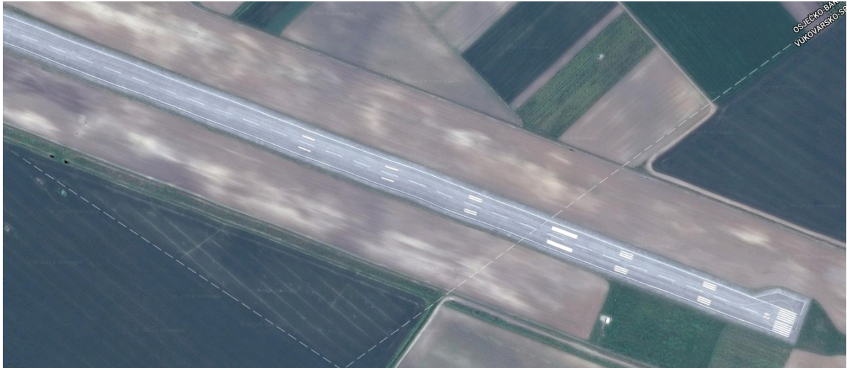
Slika 25. Oznake manevarske površine zračne luke Osijek na strani praga 29
