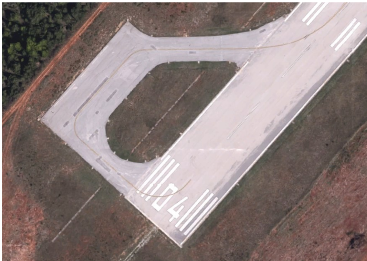
Slika 45. Oznaka okretišta na pragu 04 zračne luke Zadar
