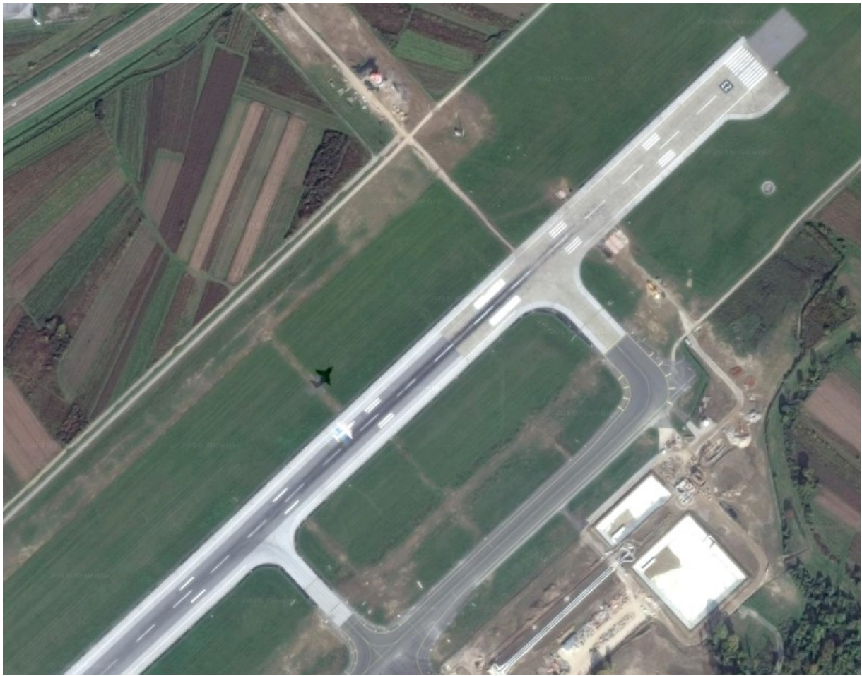
Slika 20. Oznake manevarske površine zračne luke Zagreb na strani praga 23
