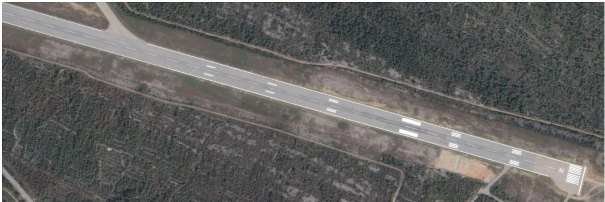
Slika 35. Oznake manevarske površine zračne luke Rijeka na strani praga 32
