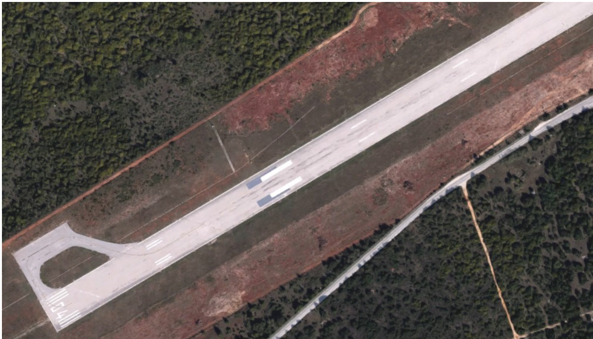
Slika 43. Oznake manevarske površine zračne luke Zadar na strani praga 04
