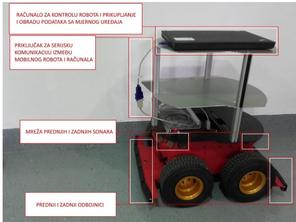
Slika 7. Fizičke komponente Pioneer 3-AT mobilnog robota
