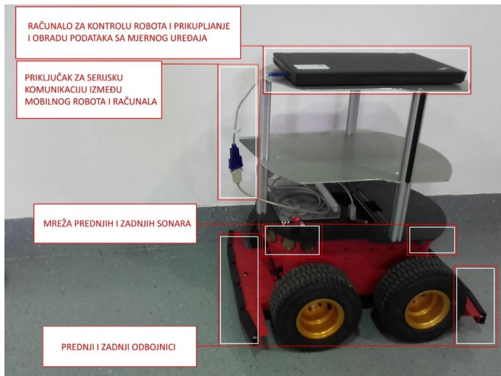
Slika 7. Fizičke komponente Pioneer 3-AT mobilnog robota
