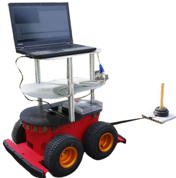
Slika 16. Simulacija uzbrdice simulacijskim kolicima
