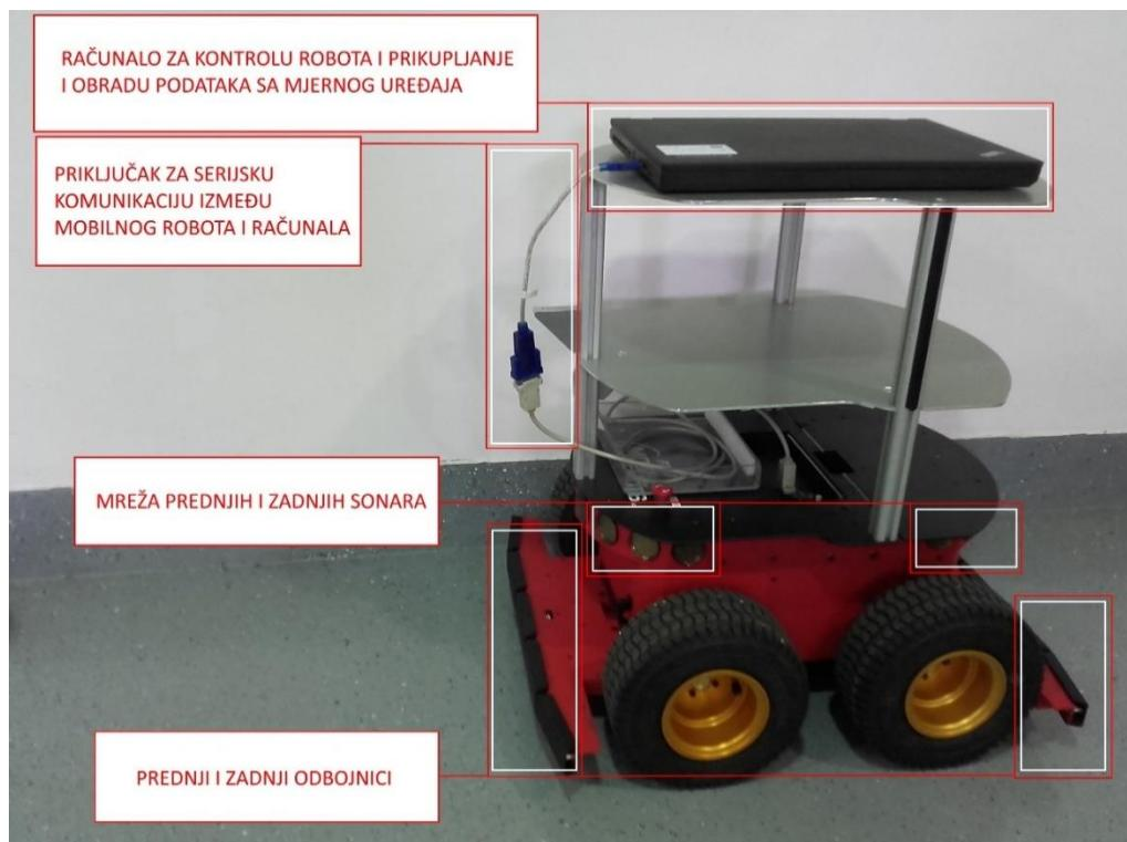
**Slika 7.** Fizičke komponente Pioneer 3-AT mobilnog robota
