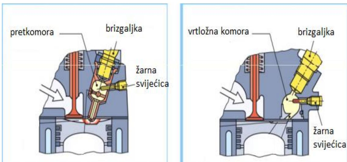
Slika 11. Dizel motori s indirektnim ubrizgavanjem, [2]
