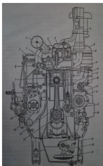
Slika 7. Poprečni presjek dizel motora tipa D-54A [24]
