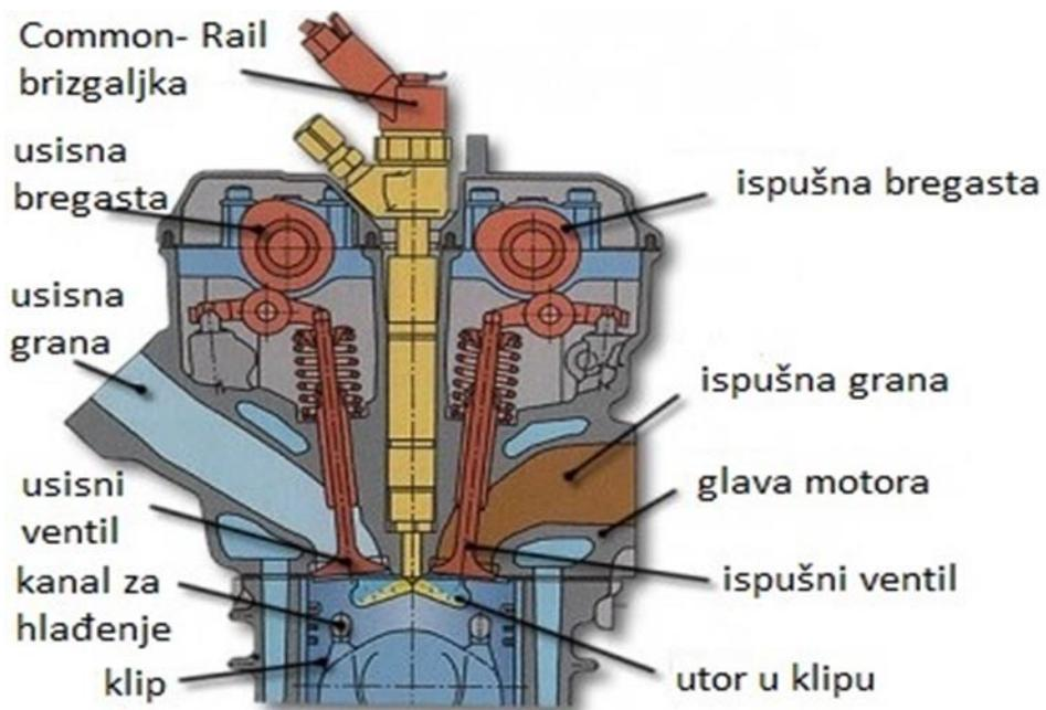
Slika 10. Dizel motor s direktnim ubrizgavanjem, [6]
