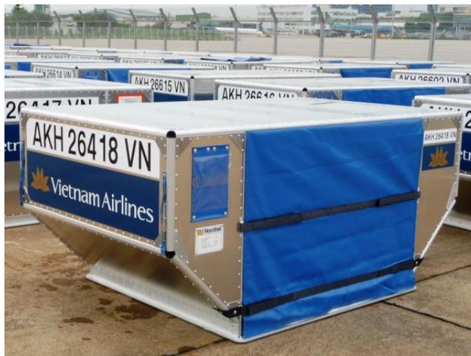
**Slika 3.1. Prikaz zrakoplovnog kontejnera**
