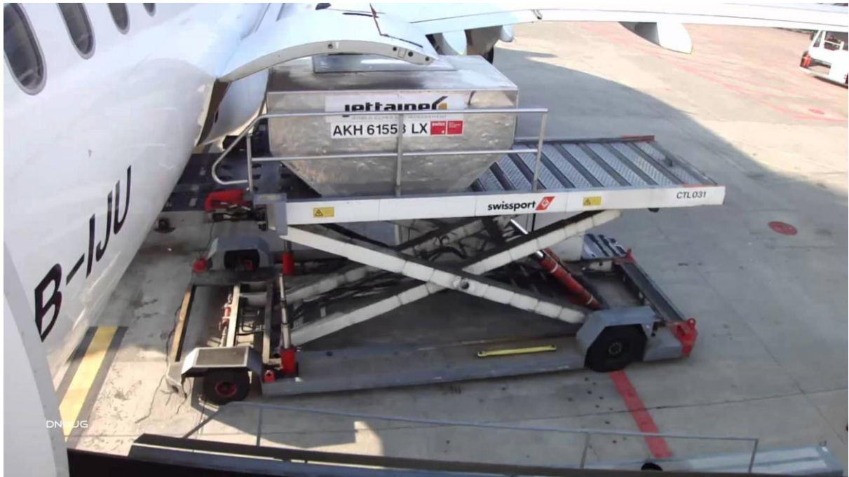
Slika 2.3. Iskrcaj tereta iz zrakoplova pomoću teretnog utovarivača
