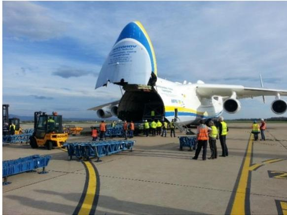
**Slika 5.2. Postupak otvaranja prednjeg nosnog dijela zrakoplova**
