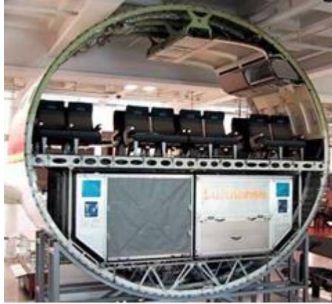
Slika 3.9. Konture ukrcajne jedinice u odnosu na putnički zrakoplov A300
