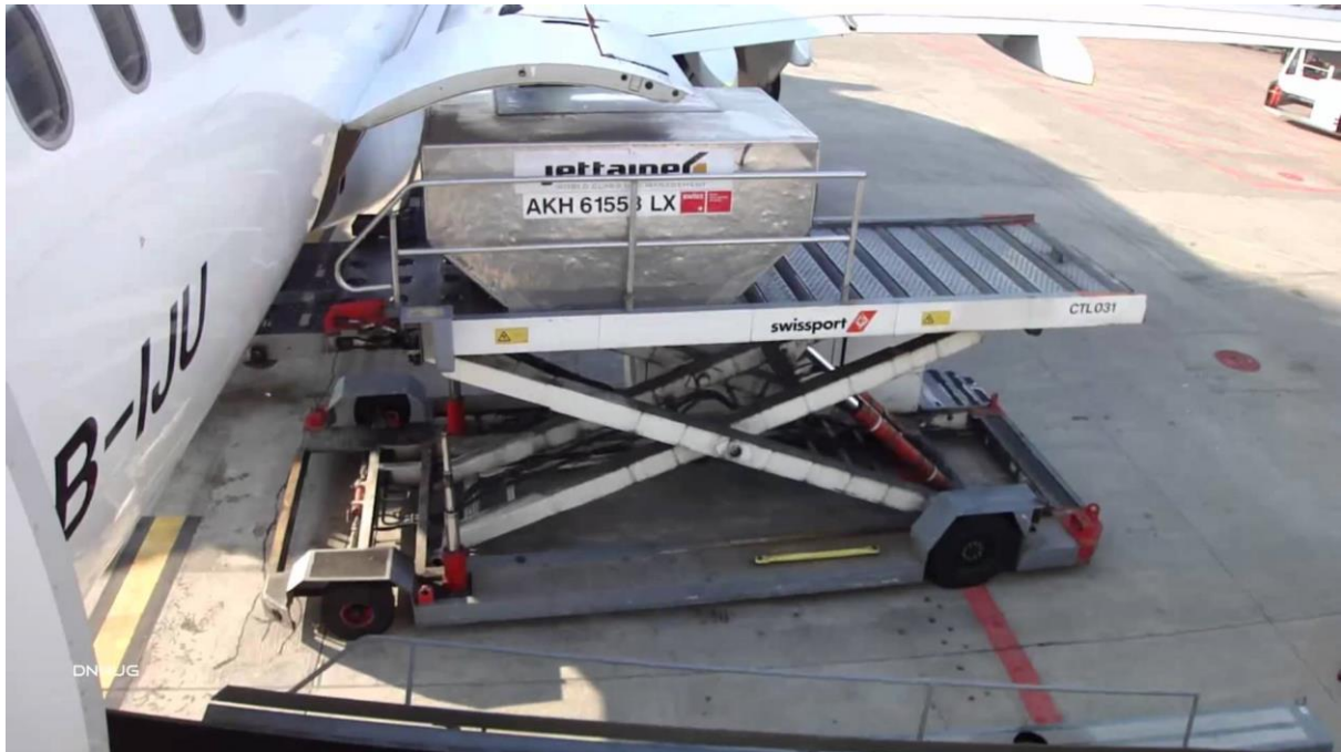
Slika 2.3. Iskrcaj tereta iz zrakoplova pomoću teretnog utovarivača
