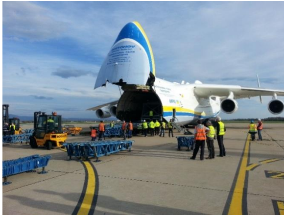
Slika 5.2. Postupak otvaranja prednjeg nosnog dijela zrakoplova
