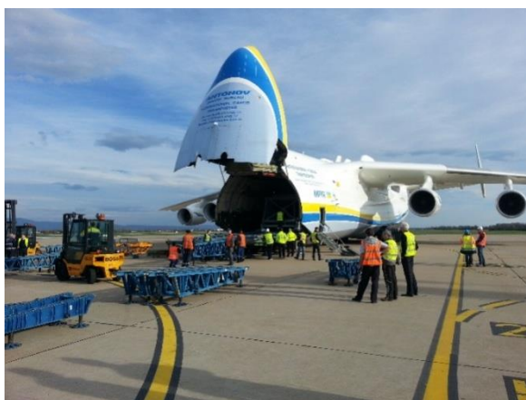
Slika 5.2. Postupak otvaranja prednjeg nosnog dijela zrakoplova
