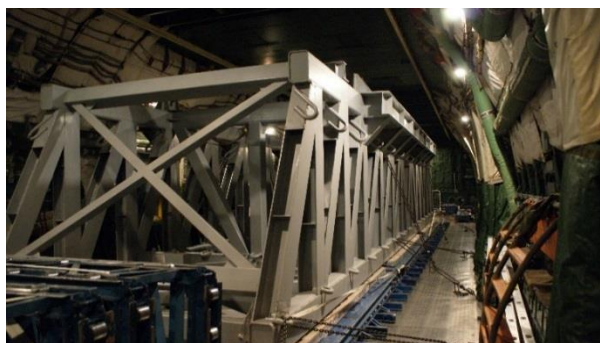
Slika 5.4. Prikaz unutrašnjosti zrakoplova i konstrukcije za prihvat tereta
