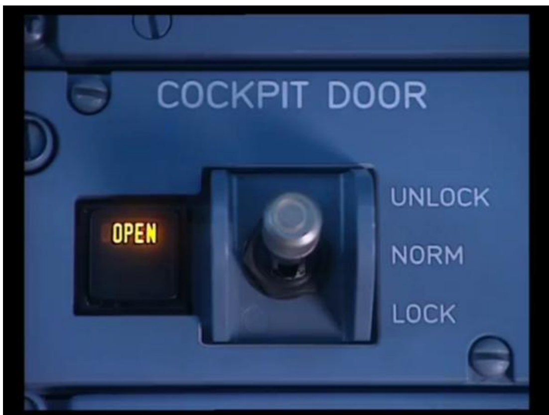
Slika 11. Sustav za automatsko zaključavanje te otključavanje vrata cockpit-a Izvor: http://image.airlinerratings.com/articles/pilot%20suicide.jpg (pristupljeno: prosinac 2016.)
