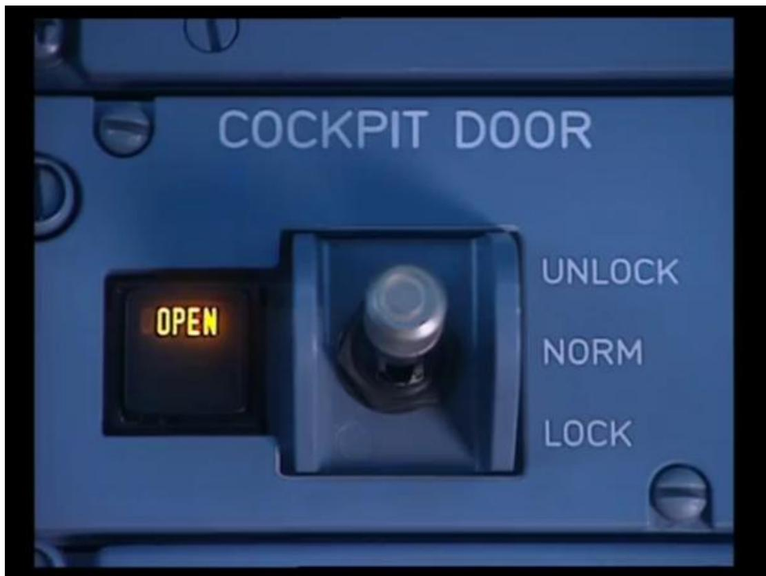
**Slika 11.** Sustav za automatsko zaključavanje te otključavanje vrata cockpit-a
