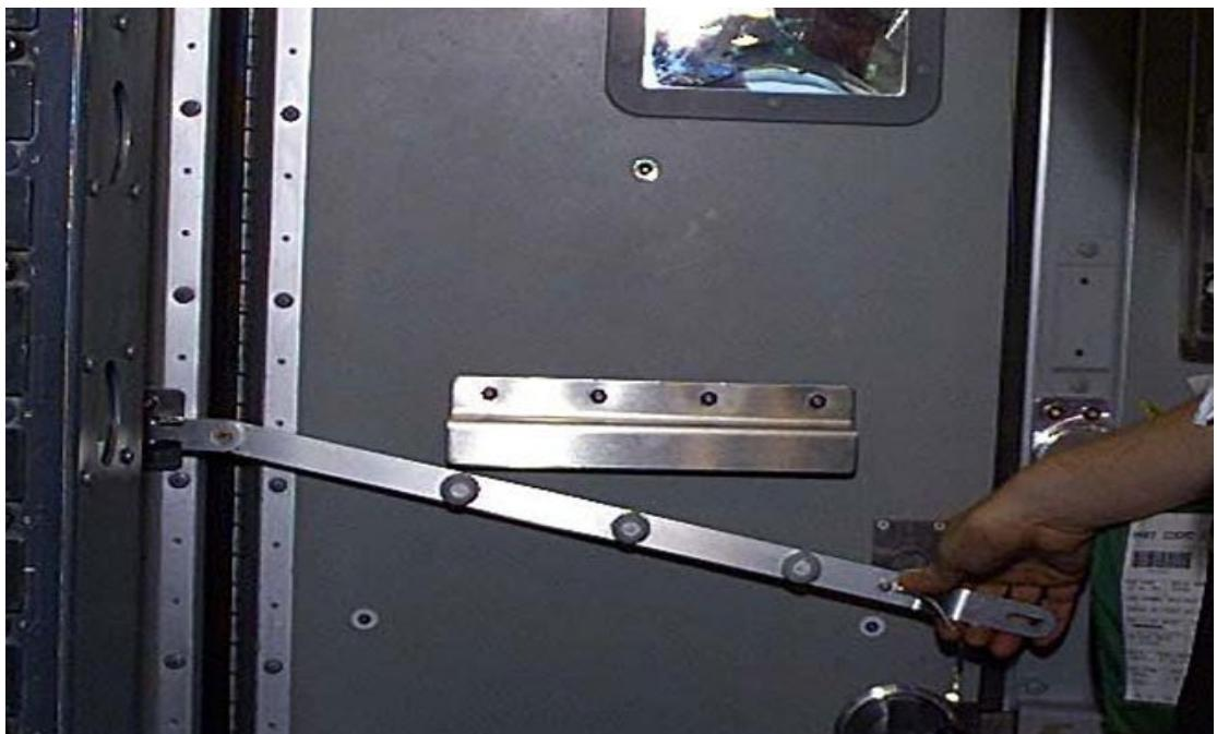
**Slika 12.** Prikaz vrata cockpit-a s ručnim tipom zaključavanja
