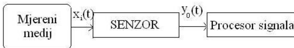
Slika 20. Input-output model senzora
