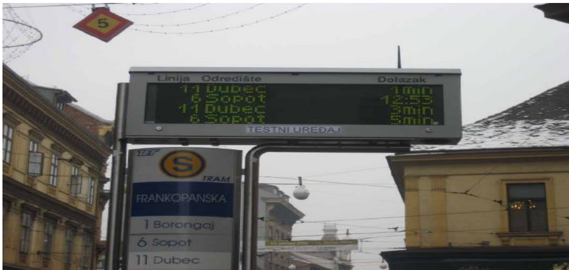
Slika 14. Displej za dinamičko informiranje putnika u gradu Zagrebu
