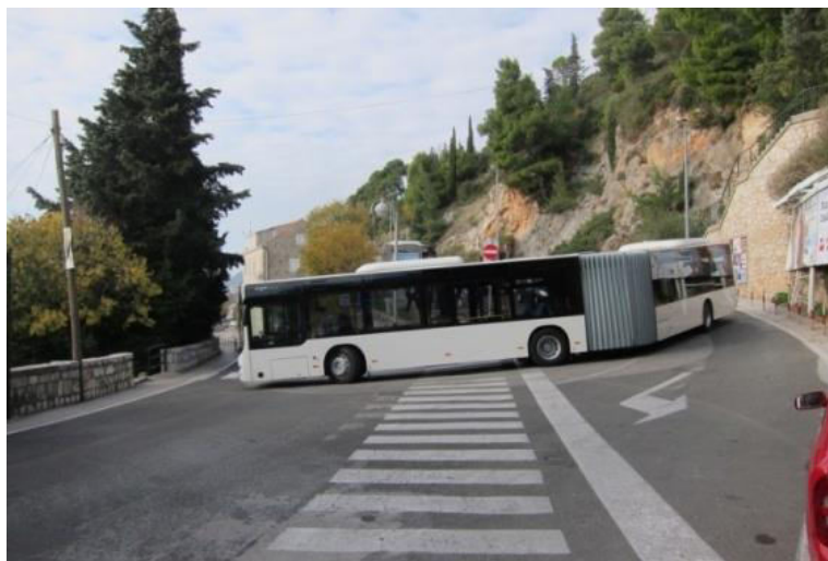
Slika 7. Zglobni troosovinski autobus u Opatiji
