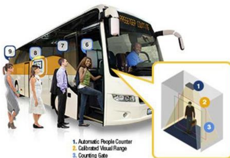
Slika 1. Automatski brojač putnika koji očitava polje preglednosti
