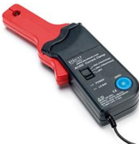
Slika 16. Stezaljka za mjerenje jakosti struje [8]
