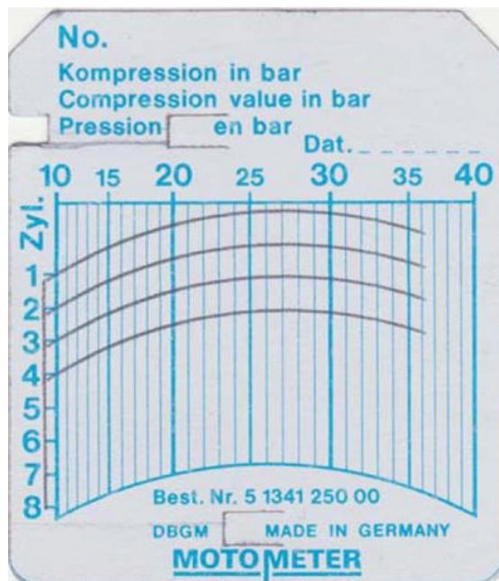
Slika 22. Izmjereni tlak kompresije na Diesel motoru [2]
