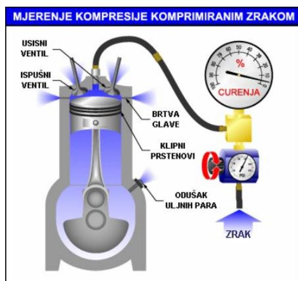
Slika 10. Shematski prikaz mjerena tlaka kompresije komprimiranim zrakom [2]
