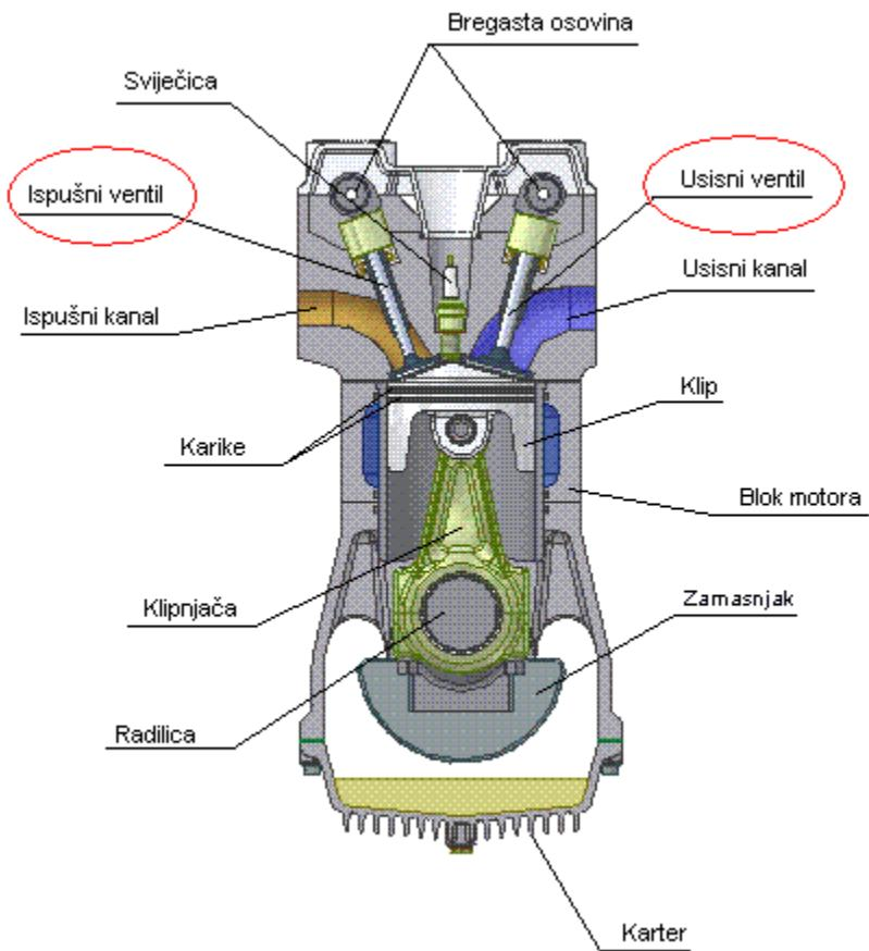
Slika 1. Konstrukcija motora [15]
