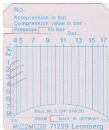
Slika 24. Izmјereni tlak sa slabom kompresijom na Otto motoru [2]
