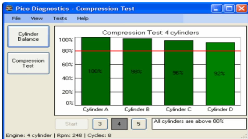
Slika 18. Prikaz mjerjenja relativne kompresije pomoću osciloskopa [9]
