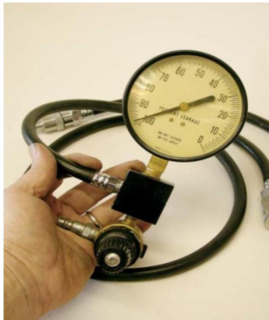
Slika 12. Instrument za mjerjenje kompresije komprimiranog zraka s jednim manometrom [2]
