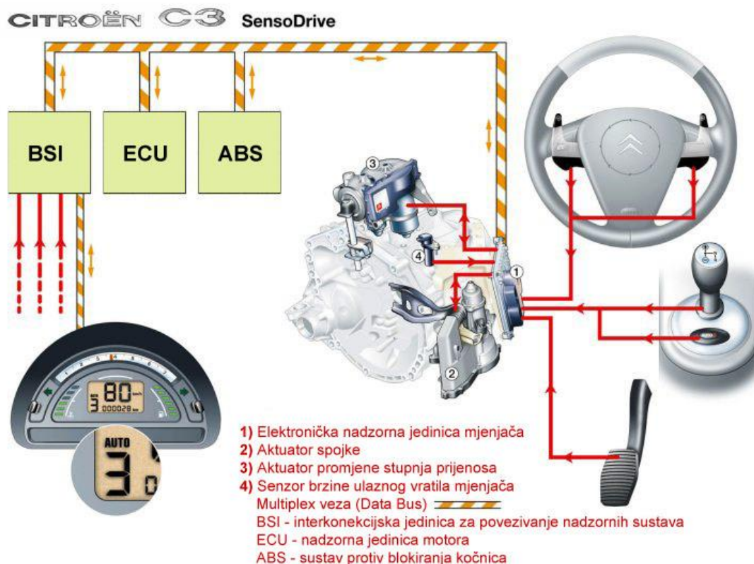
Slika 15. Primjer upravljačkog i nadzornog sustava automatskog mjenjača kod vozila marke Citroen [22]
