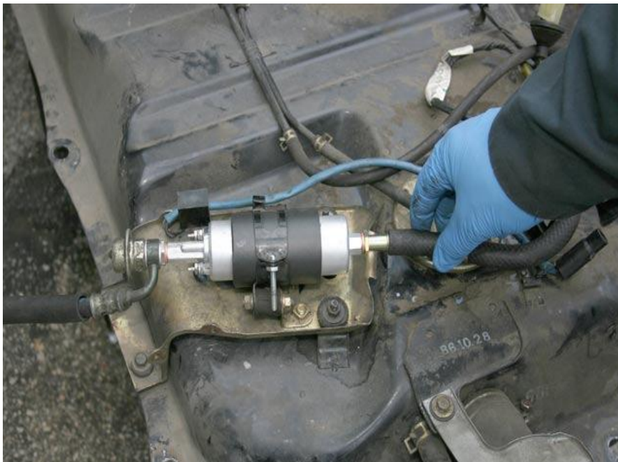
Slika 10. Pumpa goriva izvan spremnika [11]
