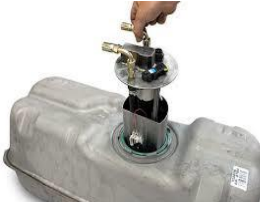
Slika 11. Pumpa goriva uronjena u spremnik [11]
