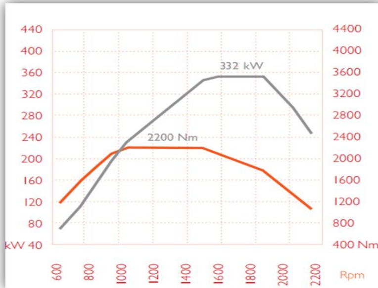
Slika 23. Krivulja snage i okretnog momenta dvaju različitih snaga Iveco motora, [14]
