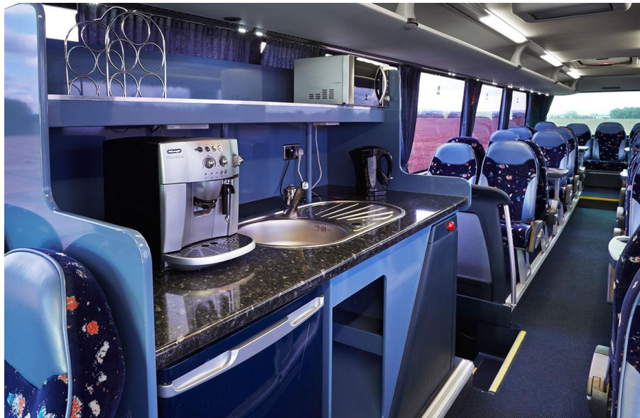
Slika 2. Tvornički proširena kuhinja u turističkom autobusu Neoplan Tourliner Izvor: http://marshalls-coaches.co.uk/about-us/our-coaches/43-57-seats-corporate-coach.php (pristupljeno 15.08.2016.)
