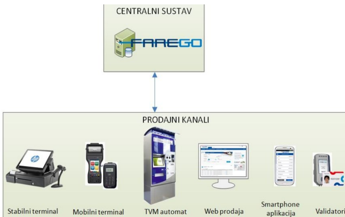
Slika 5. Centralni dio ISPRO sustava [13]
