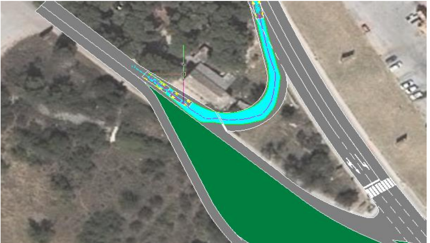
Slika 19. Traektorije teretnog vozila (kamion s prikolicom) izrađene programskim alatom AutoTURN za četverokrako raskrižje
