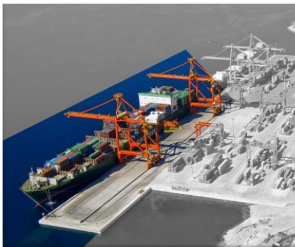
Slika 8. Obalna Panamax i Post Panamax dizalice
